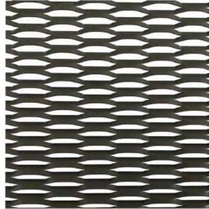
网 孔: 15*75mm 厚 度: 2.0mm 梗 宽: 6mm 开孔率: 20%
